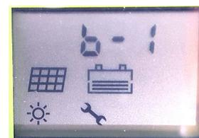
b1: Baterías plomo ácido de ciclo profundo y AGM
